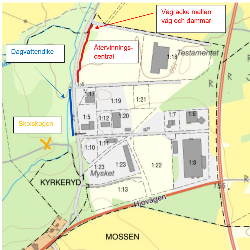
Figur 2: Rödmarkeringen på bilden är ett räcke som ska förhindra bilar att köra ner i dagvattendammarna. Det innebär också att vägbanan blev smalare och fotgängare och cyklister riskerar att klämmas mellan fordon och räcke. Den blå markeringen är det dagvattendike som anlades i samband med att dammarna för dagvattenhantering byggdes. "Skolskogen" som bland annat nyttjas av Kråkerydsskolan är markerad med ett orange kryss.
