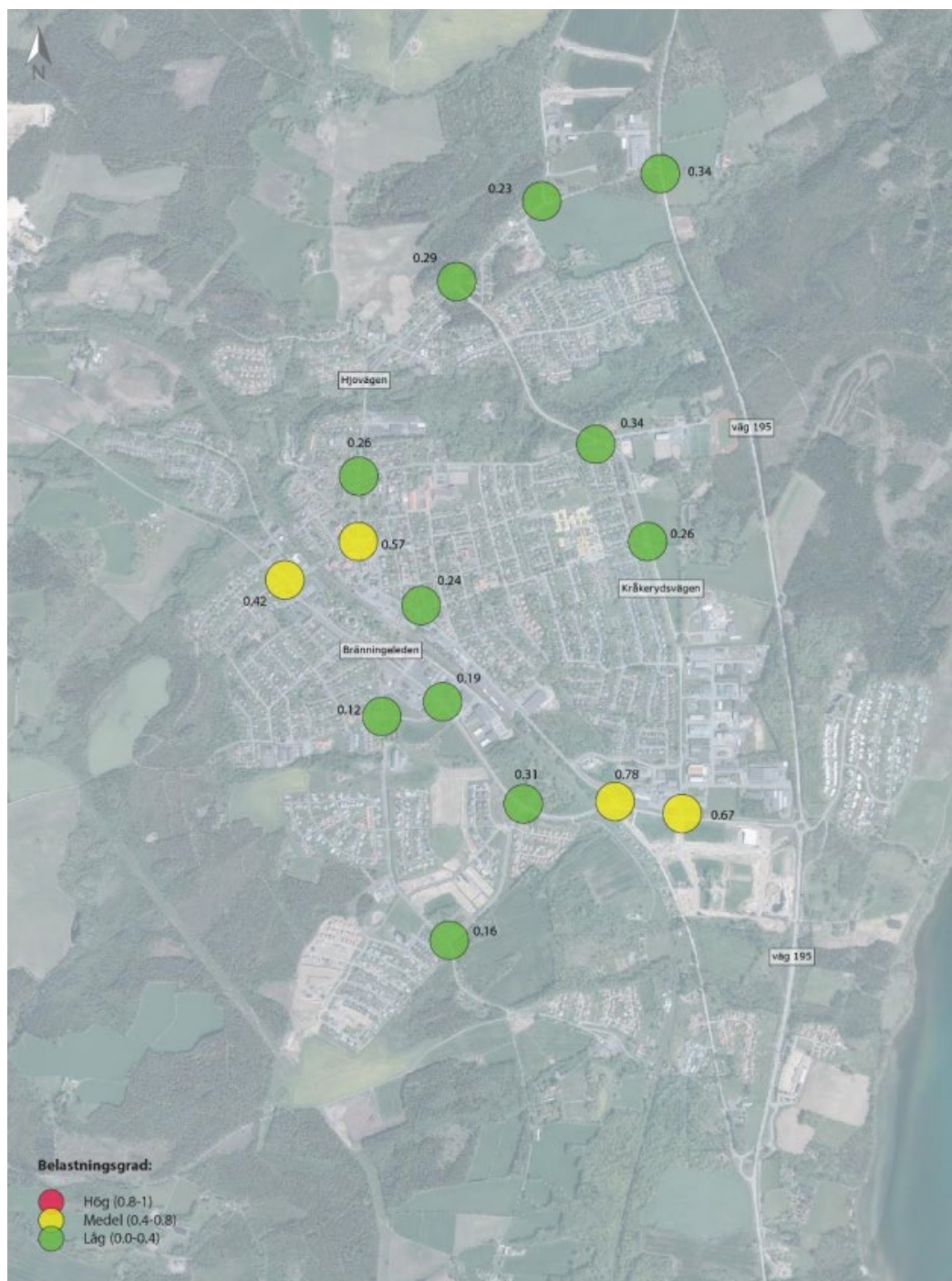
Figur 4. Korsningsanalys med hjälp av verktyget CapCal. Siffror i illustrationen visar på korsningens belastningsgrad. Trafikutredning Habo
